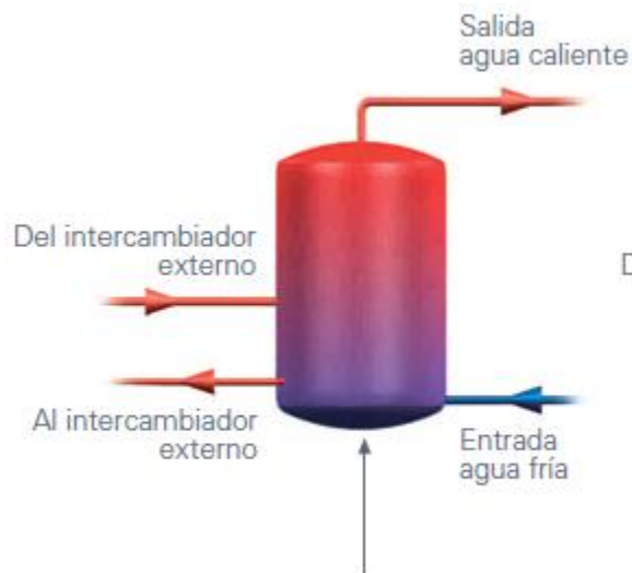
Acumulador sin intercambiador
