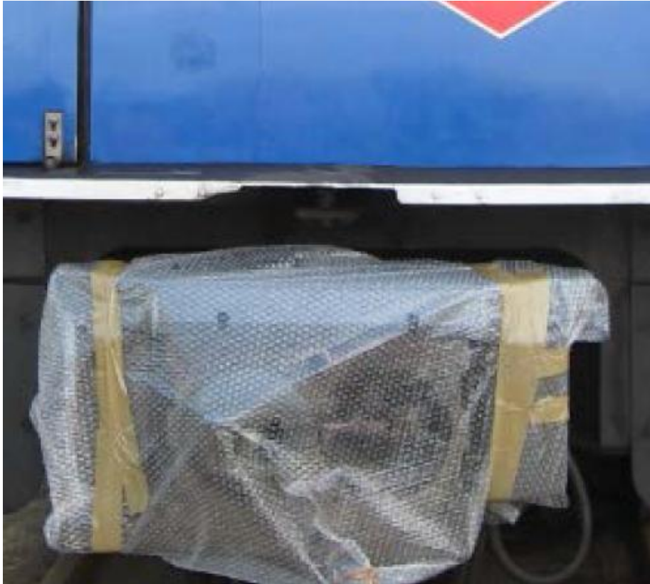
Imagen 15 – Acople automático protegido con papel burbuja
