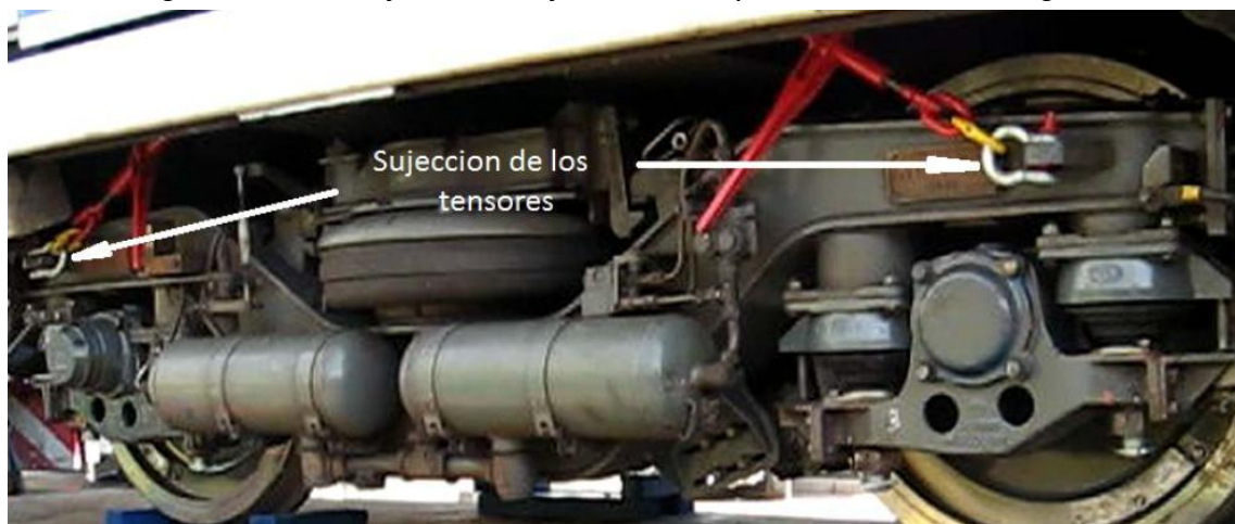
Imagen 0 – Ubicación de fijación de los tensores
