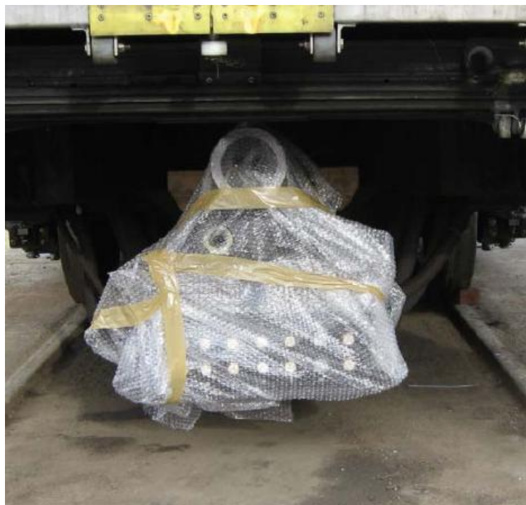
Imagen 14 – Acople semipermanente protegido con papel burbuja
