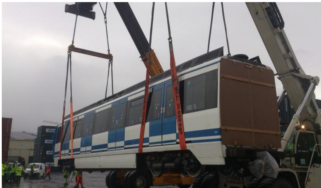
Imagen 10 – Vista de izaje. Posición de eslingas y perchas de izaje.
