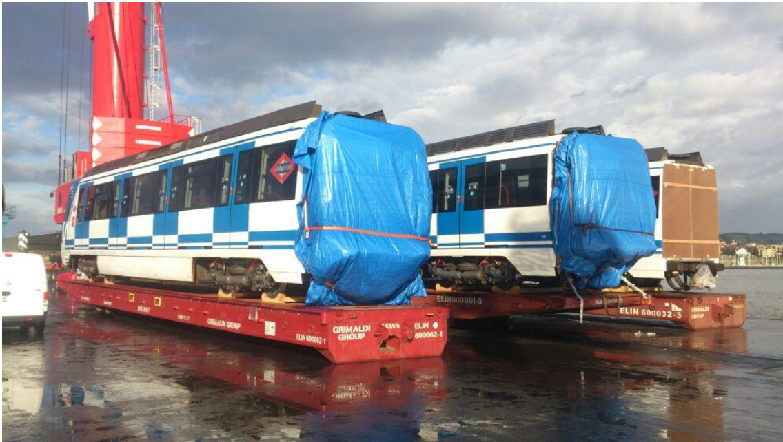
Imagen 13 – Vista de las protecciones de los extremos con fuelle (primeros 2 coches) y extremo sin fuelle con protección de terciado fenólico resistente al agua (3er coche)
