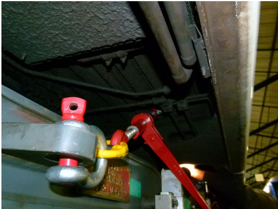
Imagen 4 – Vista de fijación del bogie al travesaño de caja
