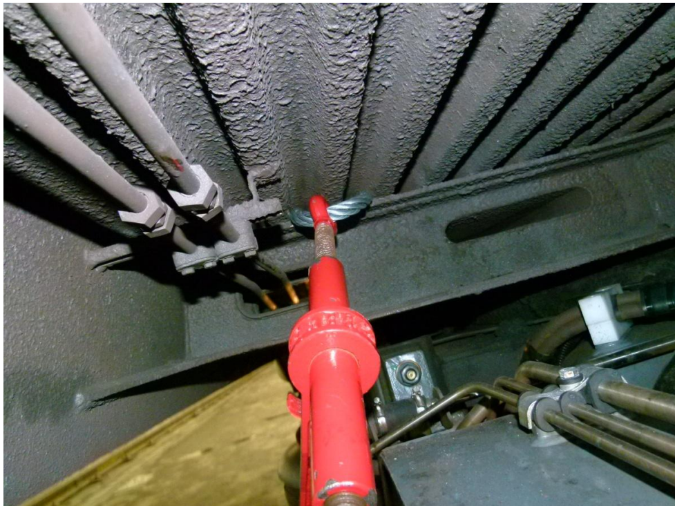
Imagen 2 – Vista de la fijación al travesaño de la caja por medio de tensor y cable. Tensor de cadena tipo L de 12 mm de diámetro y 4Tn de capacidad. Cable de acero y alma textil (3x37+1) de diámetro 18 mm (carga a la rotura mínima de 17,5 Toneladas).
