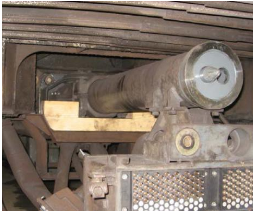
Imagen 16 – Cuña de fijación en acoples semipermanentes.
