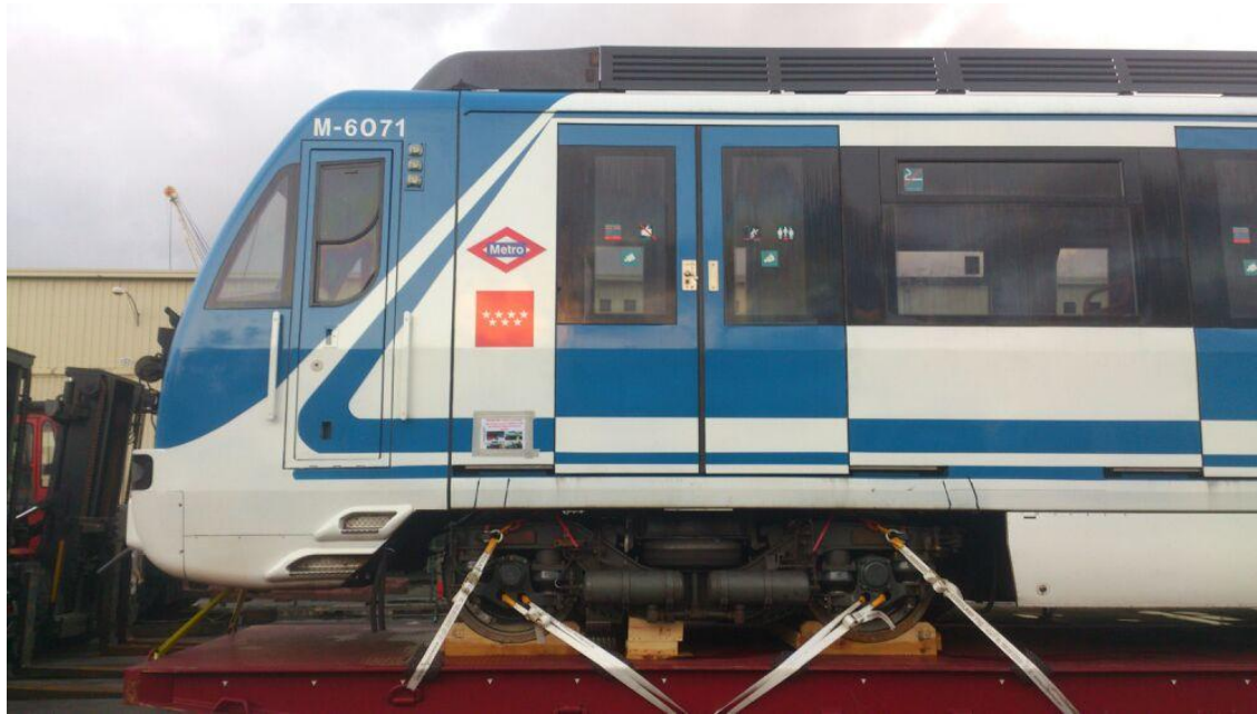
Imagen 17 – Ubicación de puntos de amarre del bogie al Mafi/ Rack Flat
