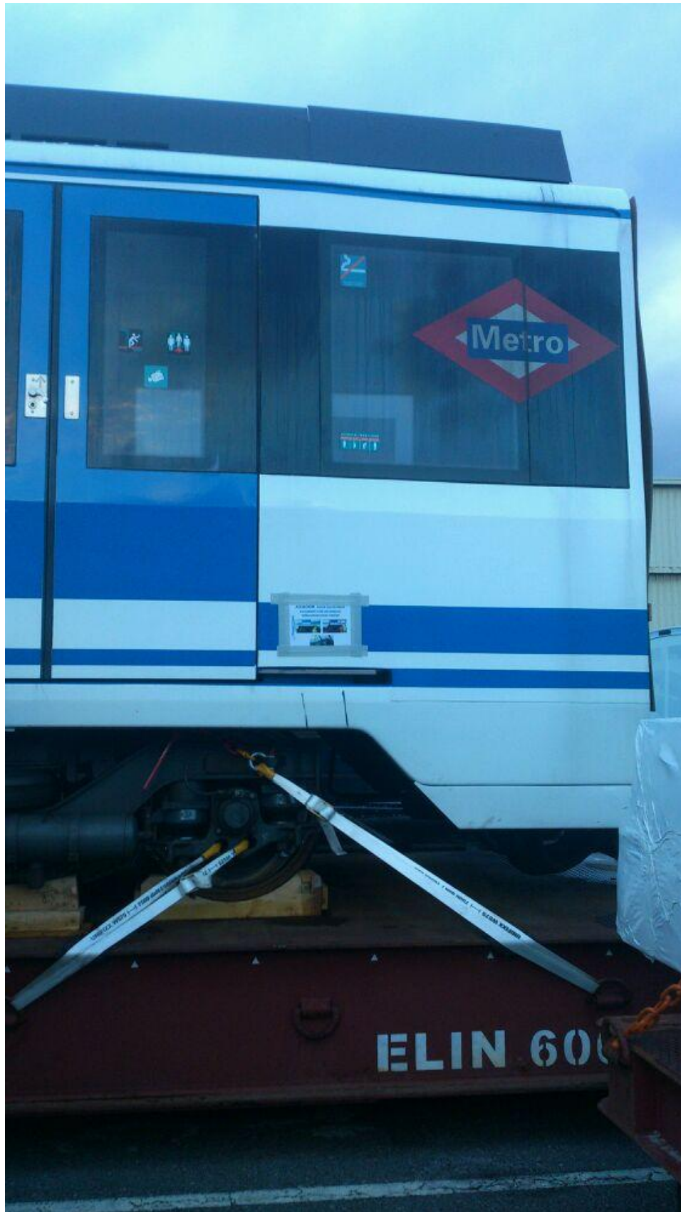
Imagen 18 – Ubicación de puntos de amarre del bogie al Mafi/ Rack Flat
