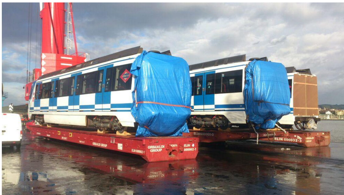
Imagen 13 – Vista de las protecciones de lo extremos con fuelle (primeros 2 coches) y extremo sin fuelle con protección de terciado fenólico resistente al agua (3er coche)
