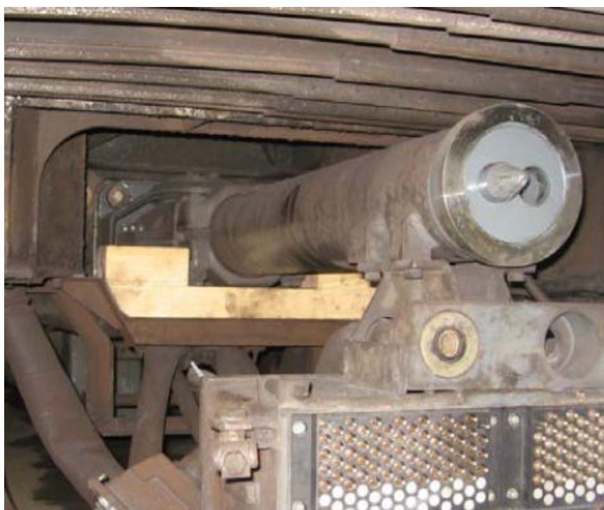
Imagen 16 – Cuña de fijación en acoples semipermanentes.
