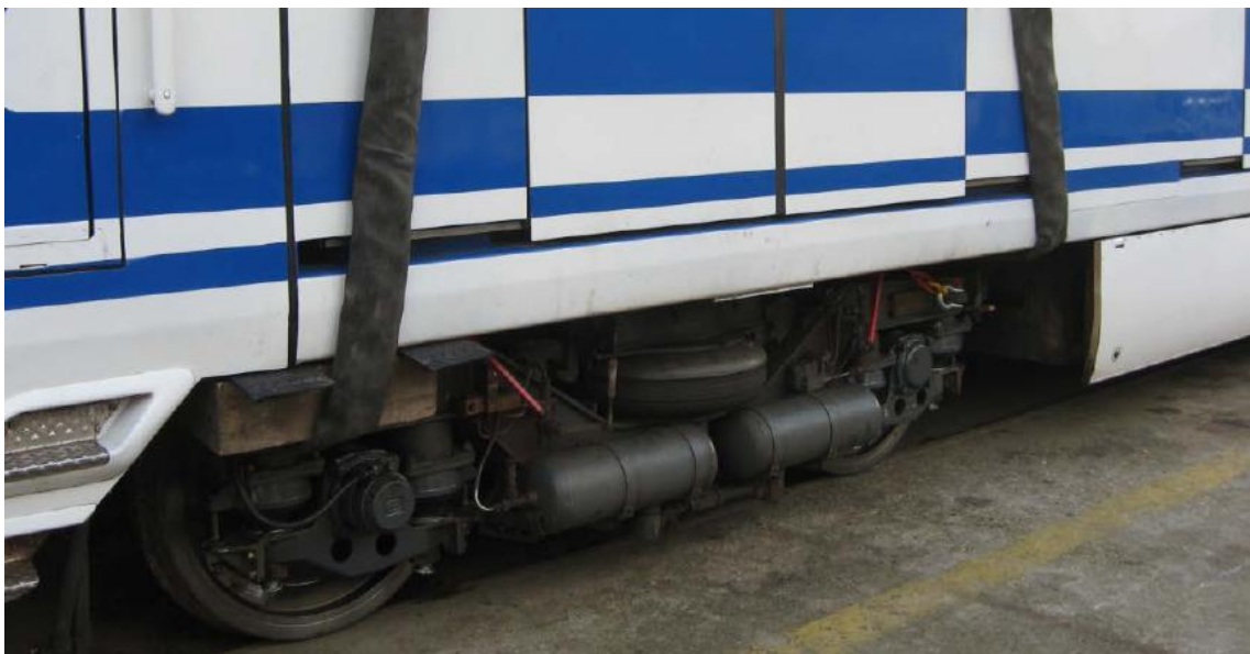
Imagen 8 – Vista de la posición del taco de madera para evitar aplastamiento de cañerías
