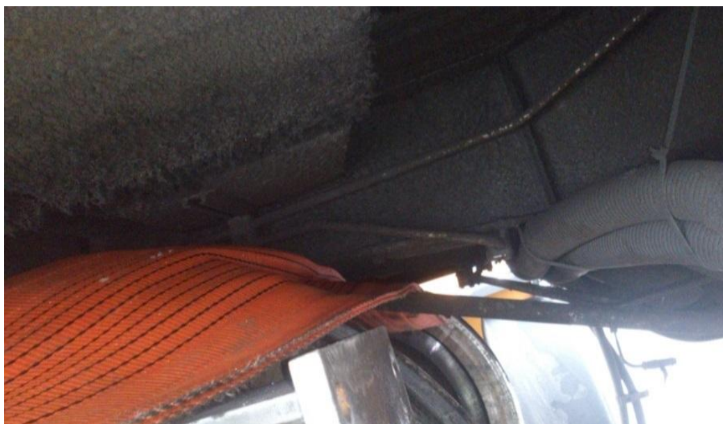
Imagen 11 – Posicionamiento inferior de la eslinga sintética.
