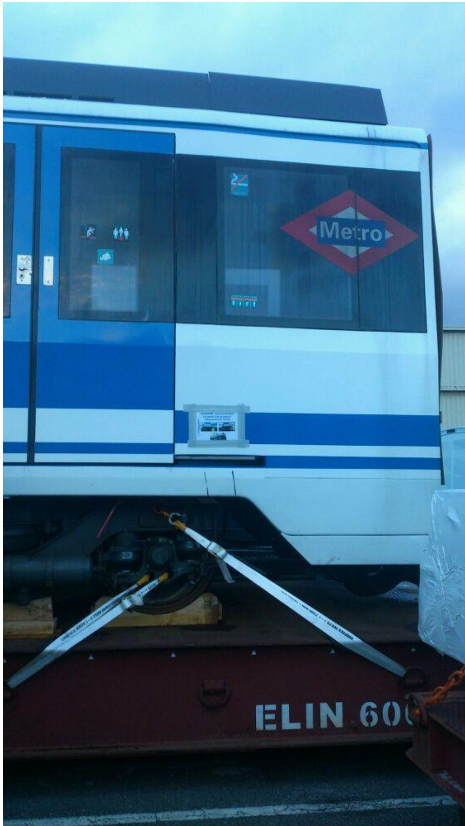
Imagen 18 – Ubicación de puntos de amarre del bogie al Mafi/ Rack Flat
