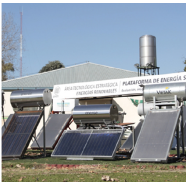
Figura 5 : Colectores solares de placa plana de industria nacional. Fuente: INTI
