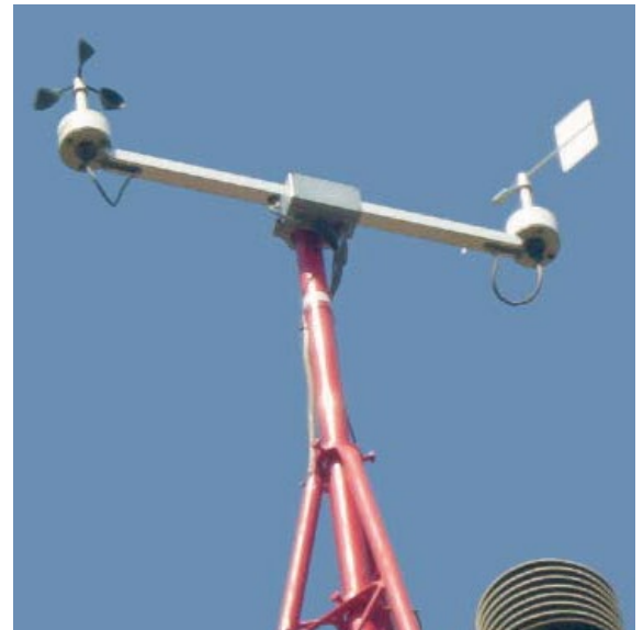
Figura 3. Anemómetro a la izquierda y veleta a la derecha (Rodríguez Jiménez et. al., 2004, p. 21).
