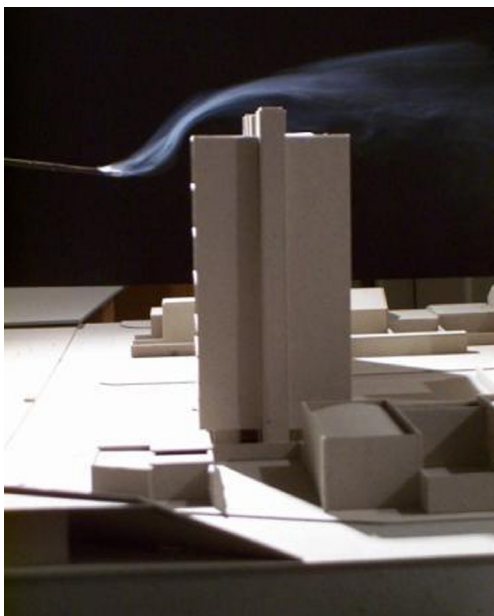
Figura 16a,16b y 16c. Ensayos en el Túnel de Viento para estudio del viento en espacios exteriores y fachadas.
