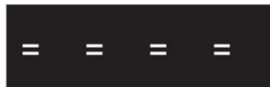
LÍNEA DE SEPARACIÓN DE SENTIDO DE CIRCULACIÓN, EN VÍAS CON SENTIDO REVERSIBLE
