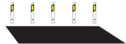
DELINEADORES (Canalizan o guían el tránsito y destacan variaciones en la vía)
