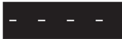
LÍNEA DE SEPARACIÓN DE SENTIDO DE CIRCULACIÓN (Indica la posibilidad de ser traspasada)
