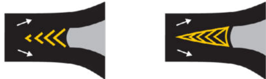
MARCAS CANALIZADORAS DE TRÁNSITO E ISLETAS PARA CIRCULACIÓN UNIDIRECCIONAL (No se puede circular sobre ellas)
