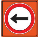
SENTIDO DE CIRCULACIÓN (Izquierda)
