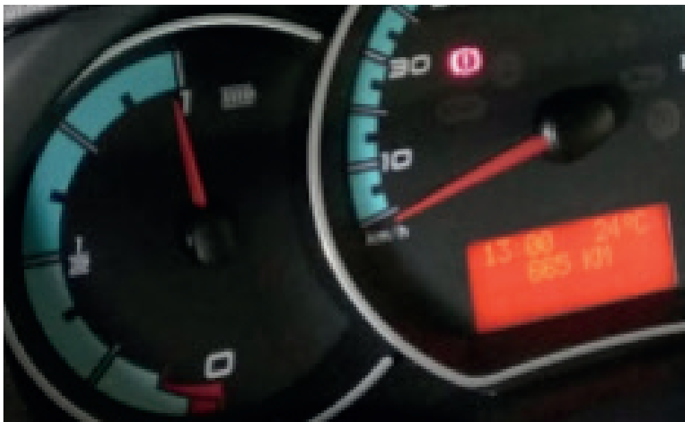
Imagen 2 - Tablero del vehículo- Reloj de la agujas del estado de carga de la batería y display de los datos de vehículo.
